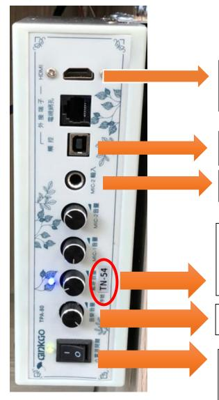
HDMI 端:連接外部電腦(影像及聲音同步由電視輸出)
